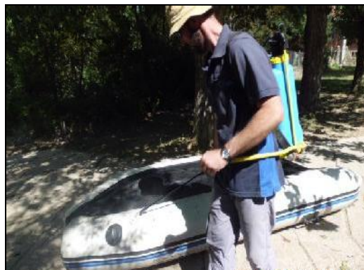
Figura 6. Desinfección mediante pulverizador
