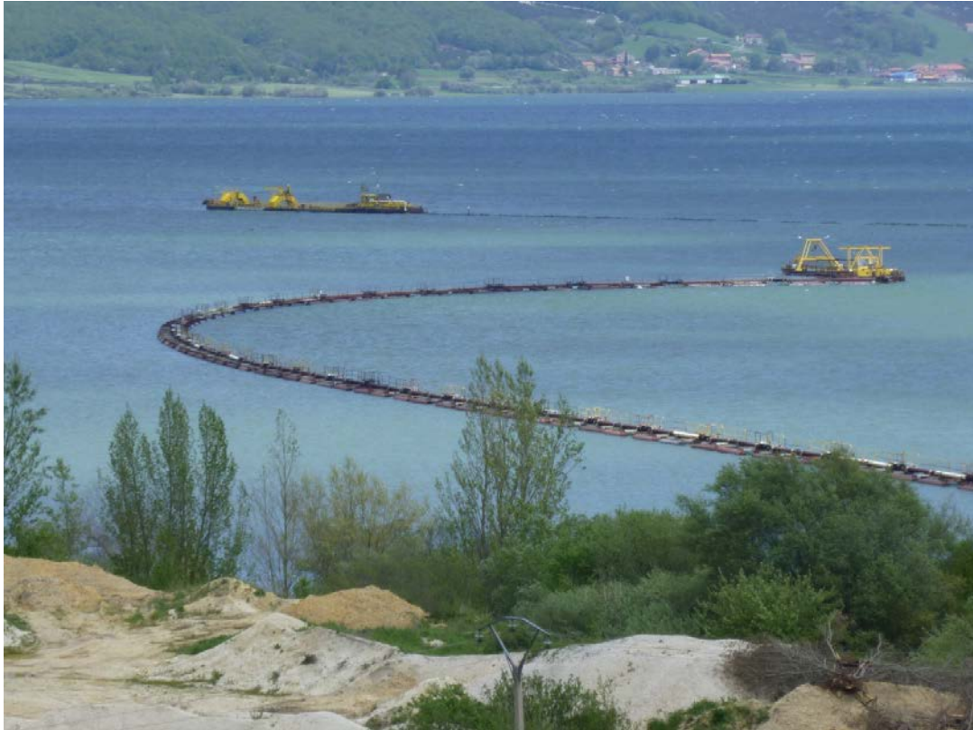
Figura 4.21. Extracción de arenas silíceas mediante dragas en el embalse del Ebro
