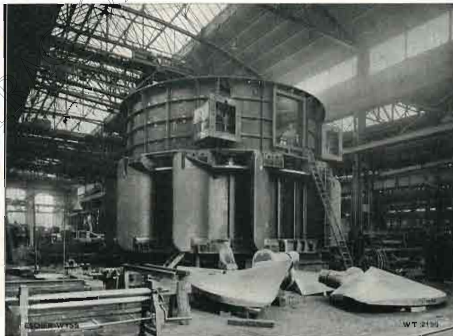
Una de las tres turbinas de 37.600 HP. para la Central de Albruck-Dogern
