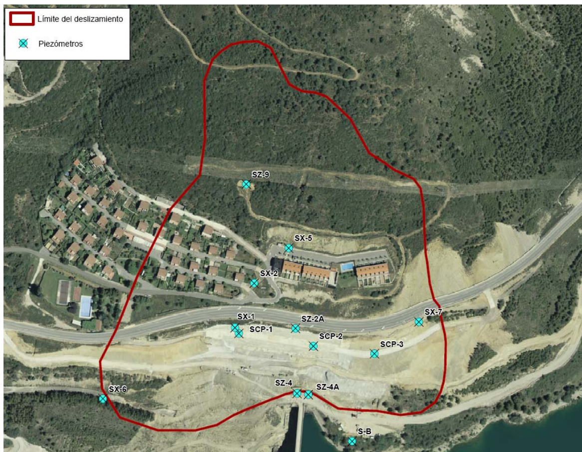
Figura 92. Situación de los piezómetros.
