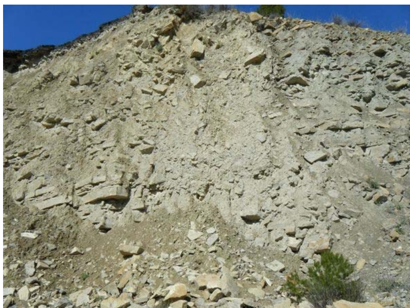
Figura 84. Plano de falla que limita el macizo rocoso estratificado y una acumulación de bloques de arenisca. Punto de lectura 25.
