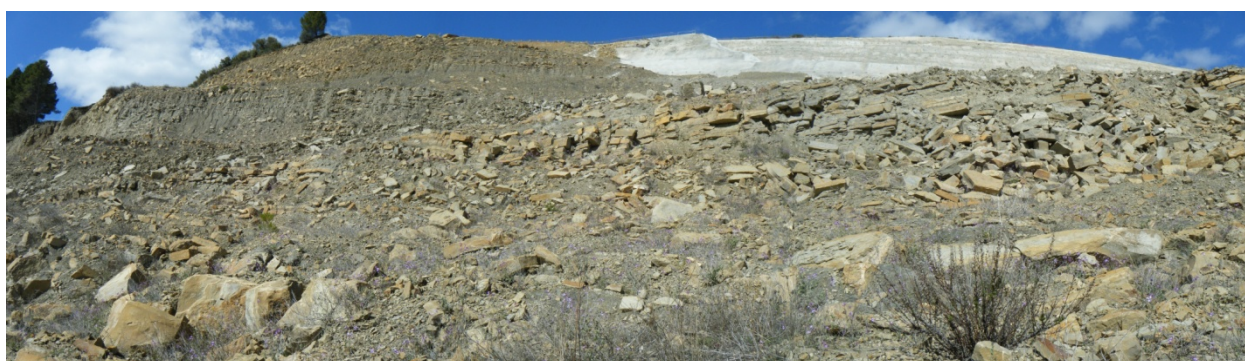
Figura 85. Capas de areniscas fracturadas con planos abiertos. Punto de lectura 23
