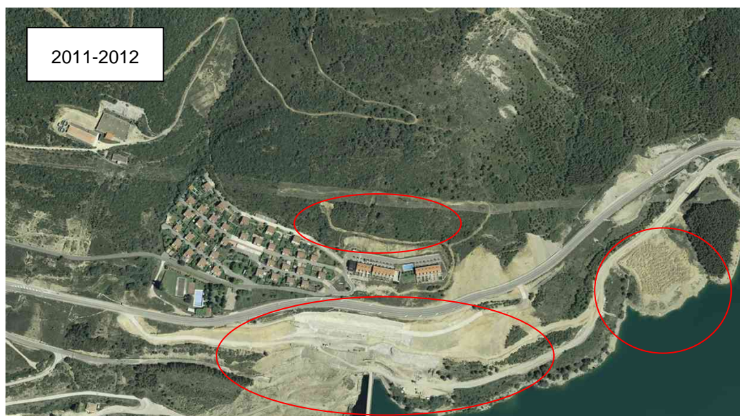
Figura 5. Se amplía el vertedero de tierras mencionado y se abren pistas para un nuevo depósito. En la zona superior de la urbanización el Mirador de Yesa.
