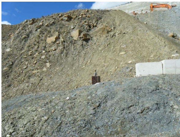
Figura 86. Contacto entre capas de areniscas y margas, que podría ser considerado la base de la zona deslizada aguas debajo de la presa. Punto de lectura 29
