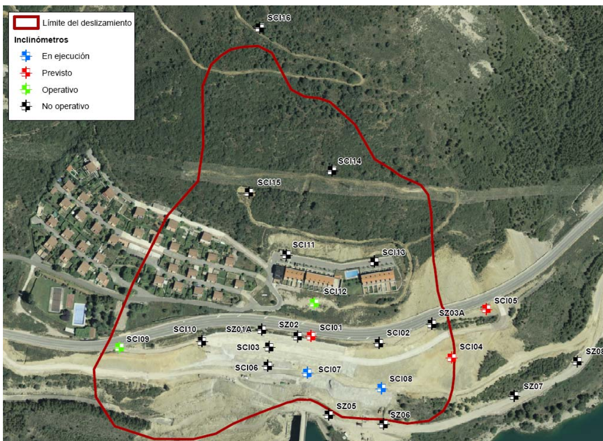
Figura 91. Situación de los inclinómetros.
