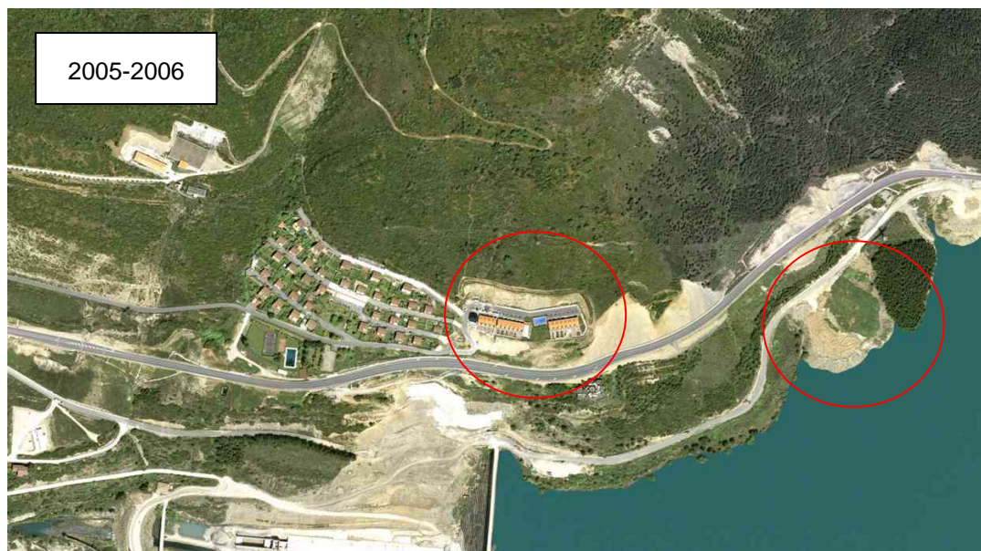
Figura 4. Se construye la urbanización Mirador de Yesa y se crea un vertedero de tierras aguas arriba de la zona inestable actualmente más activa.
