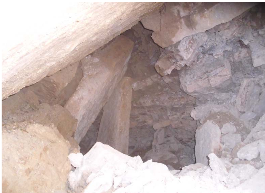
Figura 3.52: Interior de la cavidad de tamaño métrico generada en el límite Oeste de las masas inestable SPR y SIR. Sus dimensiones parecen indicar que el movimiento ocurrido recientemente debía ser la reactivación de un deslizamiento anterior, dado que no se ha registrado tanta deformación recientemente.
