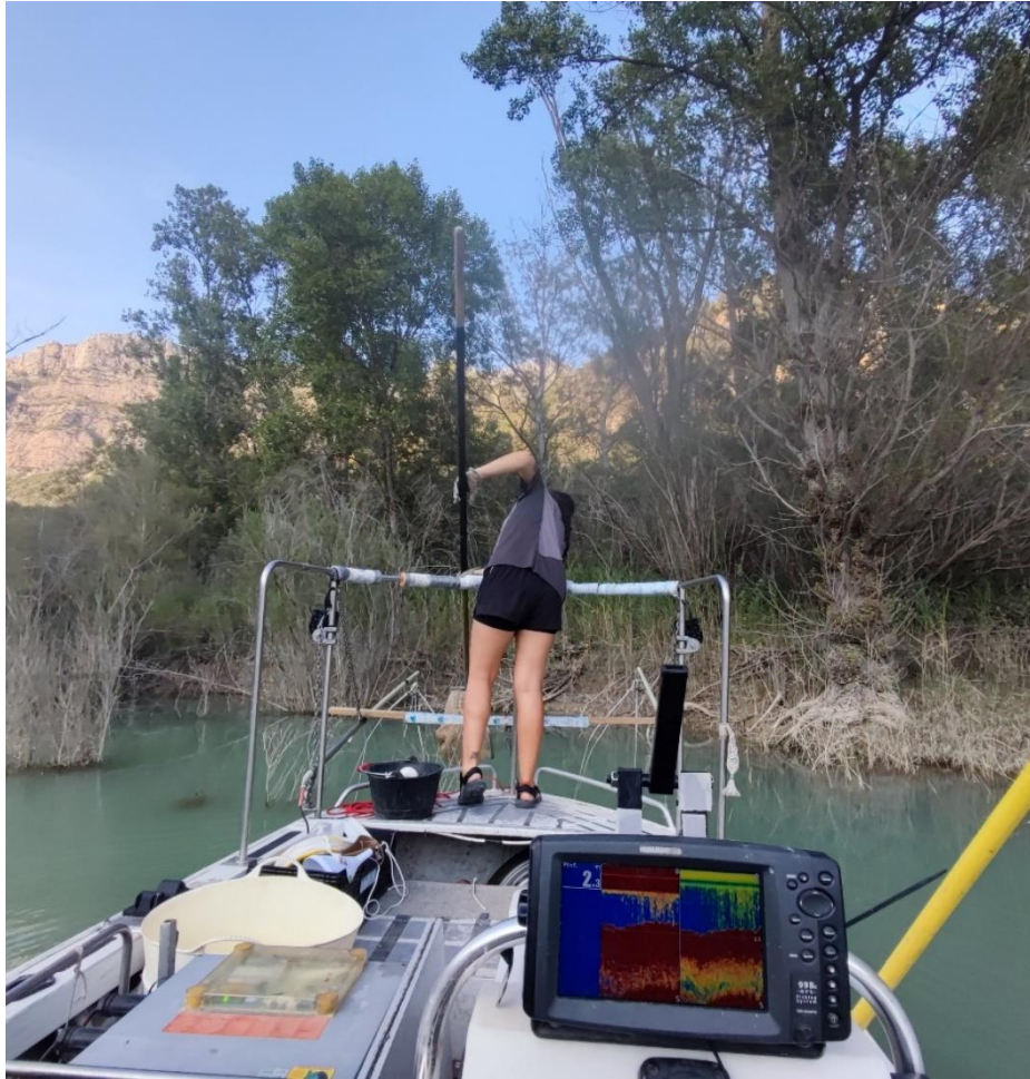
Figura 9. Equipo de electropesca desde embarcación en el embalse de Santa Ana
