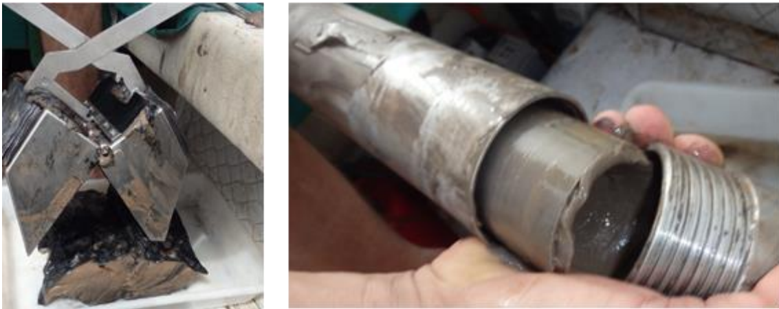
Figura 5. Draga Van Veen y dispositivo para toma de muestras inalteradas CORE
