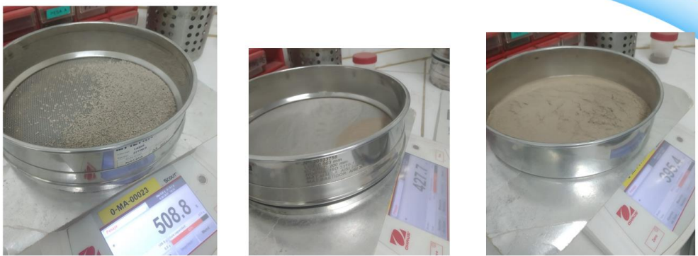
Figura 95 Pesaje de los distintos tamices.
