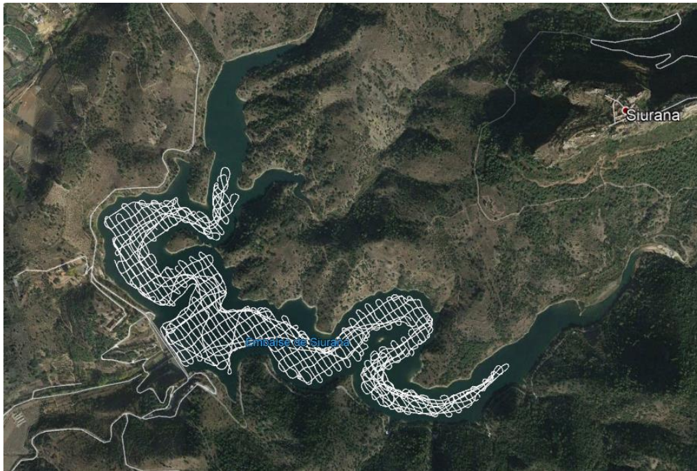
Figura 68 Navegación realizada para el levantamiento geofísico.
