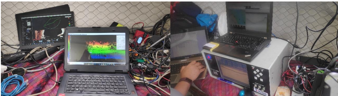
Figura 37 Ordenador de control de navegación con pantalla del operador instalado a bordo. Batimetría + LIDAR (izda) y sísmica (dcha).
