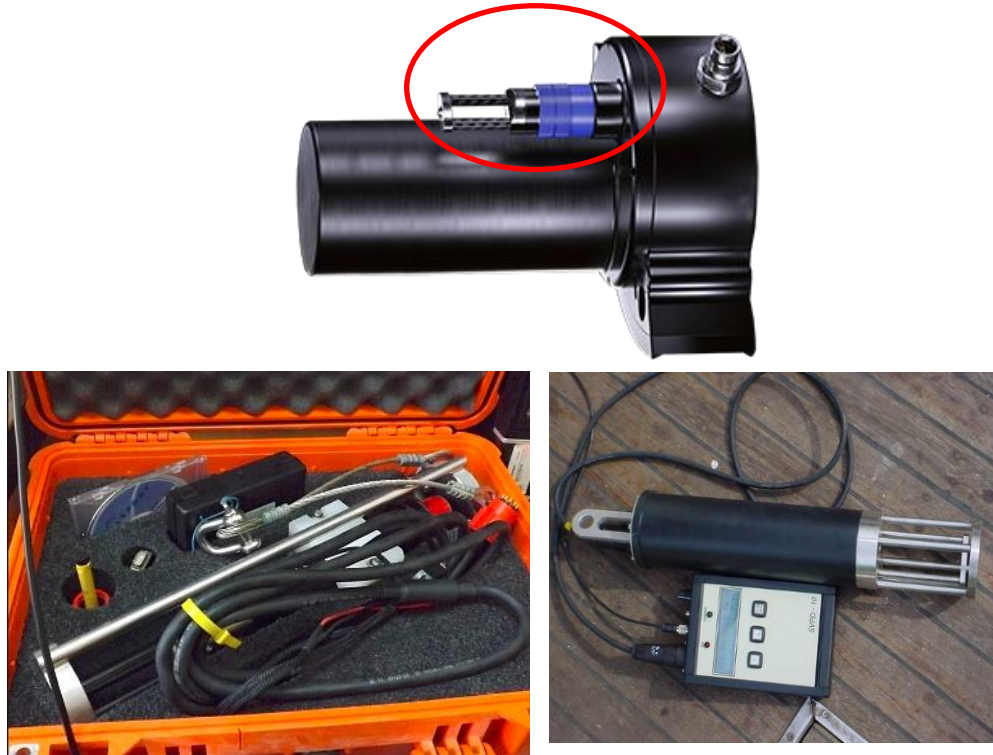
Figura 41 Sensor de la velocidad del sonido en superficie (arriba). Sensor de velocidad del sonido en la columna de agua (abajo.).
