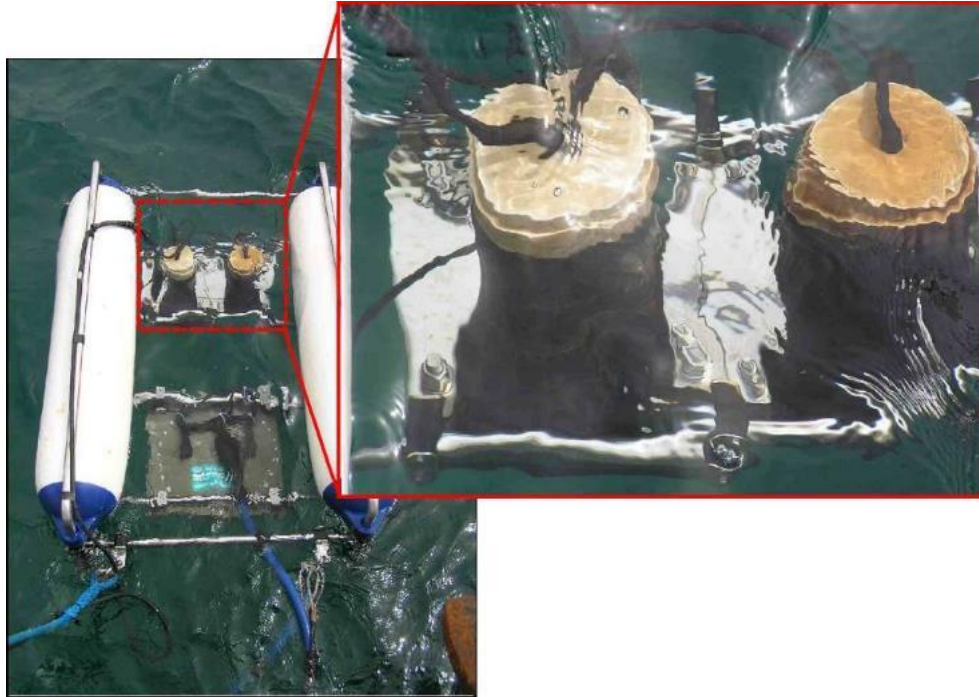
Figura 50. Receptor de 3.5KHz asociado al Geopulse
