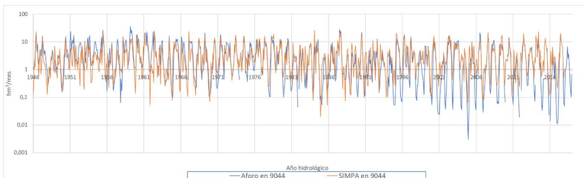
Figura 7. Comparación de la serie de aportación registrada en las estaciones 9044 Río Cidacos en Yanguas con la natural simulada mediante SIMPA (hm 3 /mes).
